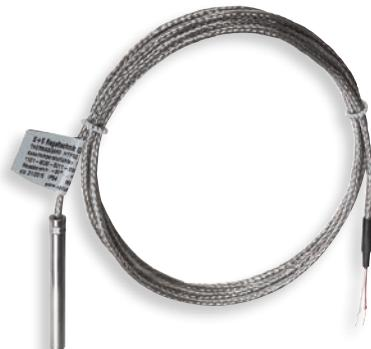
Der Hülsenfühler / Kabelfühler **THERMASGARD® HTF** dient zur Erfassung von Temperaturen in flüssigen und gasförmigen Medien. Er kann als Kanalführer sowie mittels Einbau in eine Tauchhülse als Tauch- und Einschraubfühler verwendet werden. Die Hülsenlänge variiert je nach Wunsch von 30...500 mm (Standard ist 50 mm bzw. 200 mm), die Kabellänge ist frei wählbar (Standard ist 1,5 m). Je nach Anwendung mit Silikon, Glasseide- oder PVC-Leitung, als Zwei-, Drei- oder Vierleiteranschluss.
